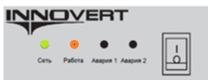
Рис.6 Индикатор «Сеть», отображающий наличие напряжения на плате управления УПП и индикатор «Работа» отображающий наличие питающего напряжения 380 В на силовых клеммах УПП.
