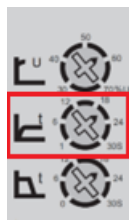
Рис.8 Потенциометр задания времени пуска электродвигателя
