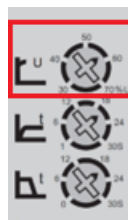
Рис.7 Потенциометр задания начального напряжения
