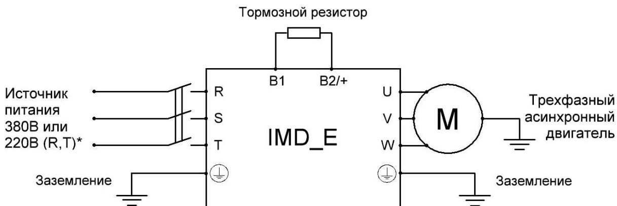
Электрическая схема подключения тормозного резистора
